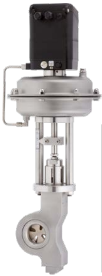
Segmentplattenventil mit Pneumatikantrieb 5020 Nennweite: DN 25 - 300 Nenndruck: PN 25 (ab DN 250 PN 16) Werkstoff: Edelstahl (ab DN 150 auch in C-Stahl) Ohne und mit Stellungsregler erhältlich Stellungsregler: pneumatisch, analog elektropneumatisch, digital elektropneumatisch, Ex-i, FM, IO-Link
