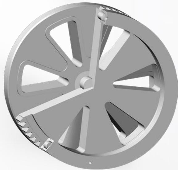
La construction spéciale des vannes segment à disque allie la précision du réglage à une étanchéité élevée, cela même dans des conditions de service extrêmes. Elles sont quasi insensibles à l'usure, même avec des fluides pollués.
