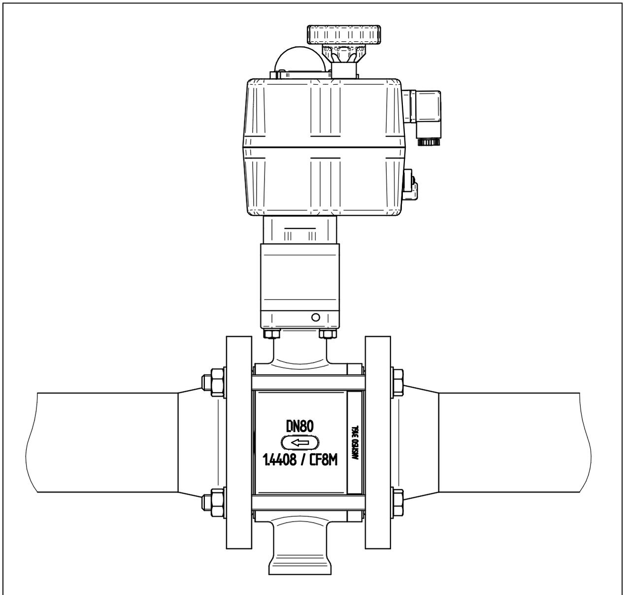
La vanne est insérée entre deux brides. Des joints conformes à la norme EN 1514-1 ou ANSI B16.21 doivent être appliqués sur les surfaces d'étanchéité dans les classes de pression respectives. Les joints striés, les joints spiralés ou tout autre joint avec anneau métallique ne conviennent pas. Nous recommandons des joints de bride en graphite pur avec insert en acier inoxydable.
