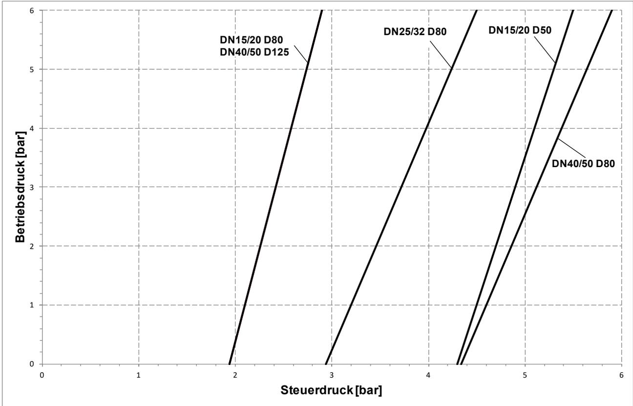
Um eine optimale Lebensdauer des Schlauches zu gewährleisten, sollte der Höchstdruck gemäß Diagramm nicht überschritten werden! Wir empfehlen die Verwendung eines Druckregelventils am Zuluftanschluss des Antriebs.
