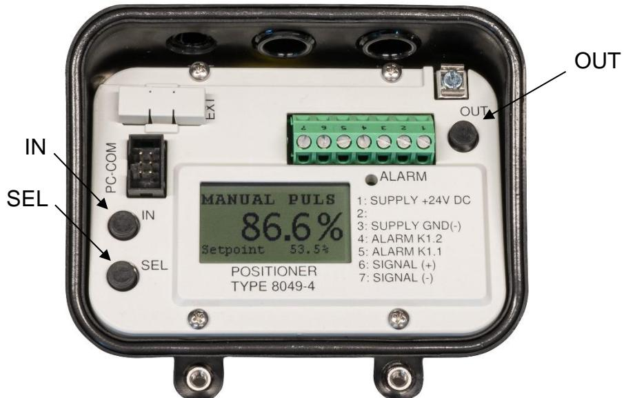
La vanne s'ouvre ou se ferme en appuyant sur les touches "IN" (air neuf dans le moteur) ou "OUT" (moteur purgé). Le régulateur de positionnement ferme l'air dans l'actionneur si aucune touche n'est actionnée.
