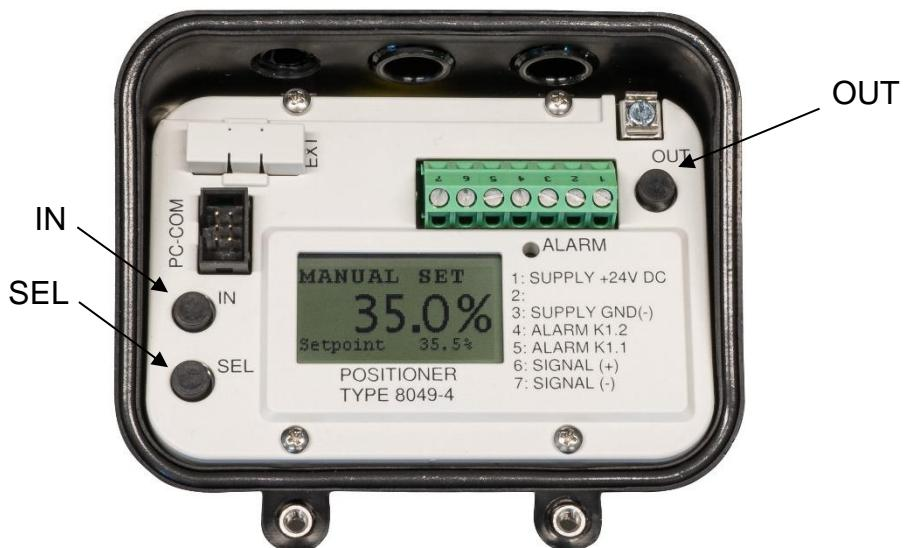
Das Ausschalten der „Manuellen Sollwertvorgabe“ erfolgt durch kurzzeitiges Drücken der Tasten IN und OUT. Das Ventil geht wieder in die Ausgangsposition entsprechend dem anliegenden Stellsignal zurück.
