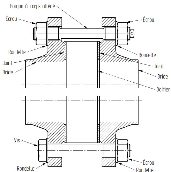
Les filetages des vis doivent être graissés. Les vis doivent être serrées en croix. Pour cela, il faut appliquer 30 % du couple de serrage de consigne lors du premier serrage, 60 % lors du deuxième serrage et 100 % lors du troisième serrage. Le processus doit ensuite être répété avec 100 % du
