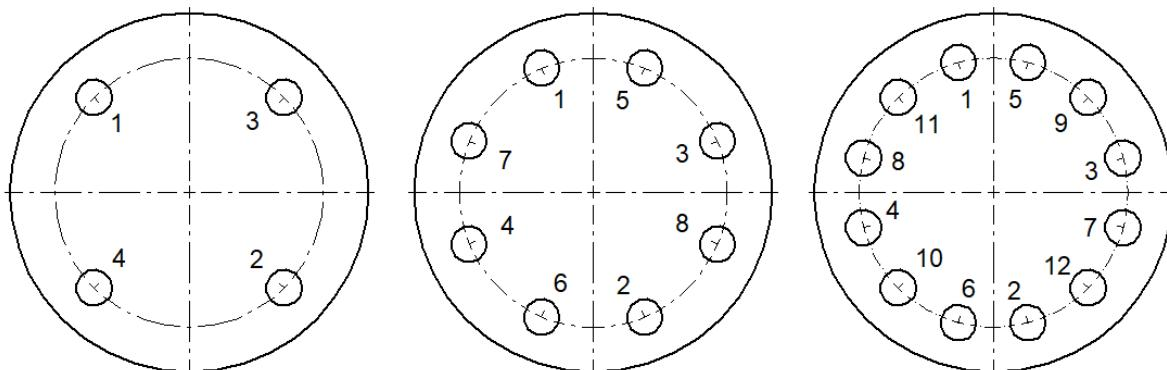
Die erforderlichen Anzugsmomente der Schrauben sind von der verwendeten Flanschdichtung abhängig. Die genauen Werte sind den entsprechenden Datenblättern zu entnehmen bzw. beim Dichtungshersteller zu erfragen.
