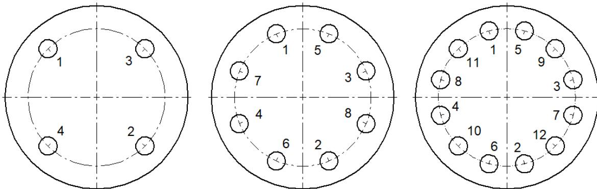
Les couples de serrage des vis requis dépendent du joint de bride utilisé. Les valeurs exactes peuvent être trouvées dans les fiches techniques correspondantes ou bien demandées auprès du fabricant de joints.
