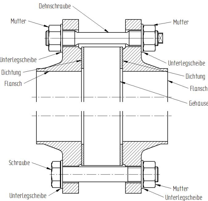
Die Gewinde der Schrauben sind zu fetten. Die Schrauben sind über Kreuz anzuziehen. Hierbei sollte beim ersten Anziehen 30%, beim zweiten Anziehen 60% und beim dritten Anziehen 100% des Sollanzugsmoments aufgebracht werden. Anschließend sollte der Vorgang mit 100% des
