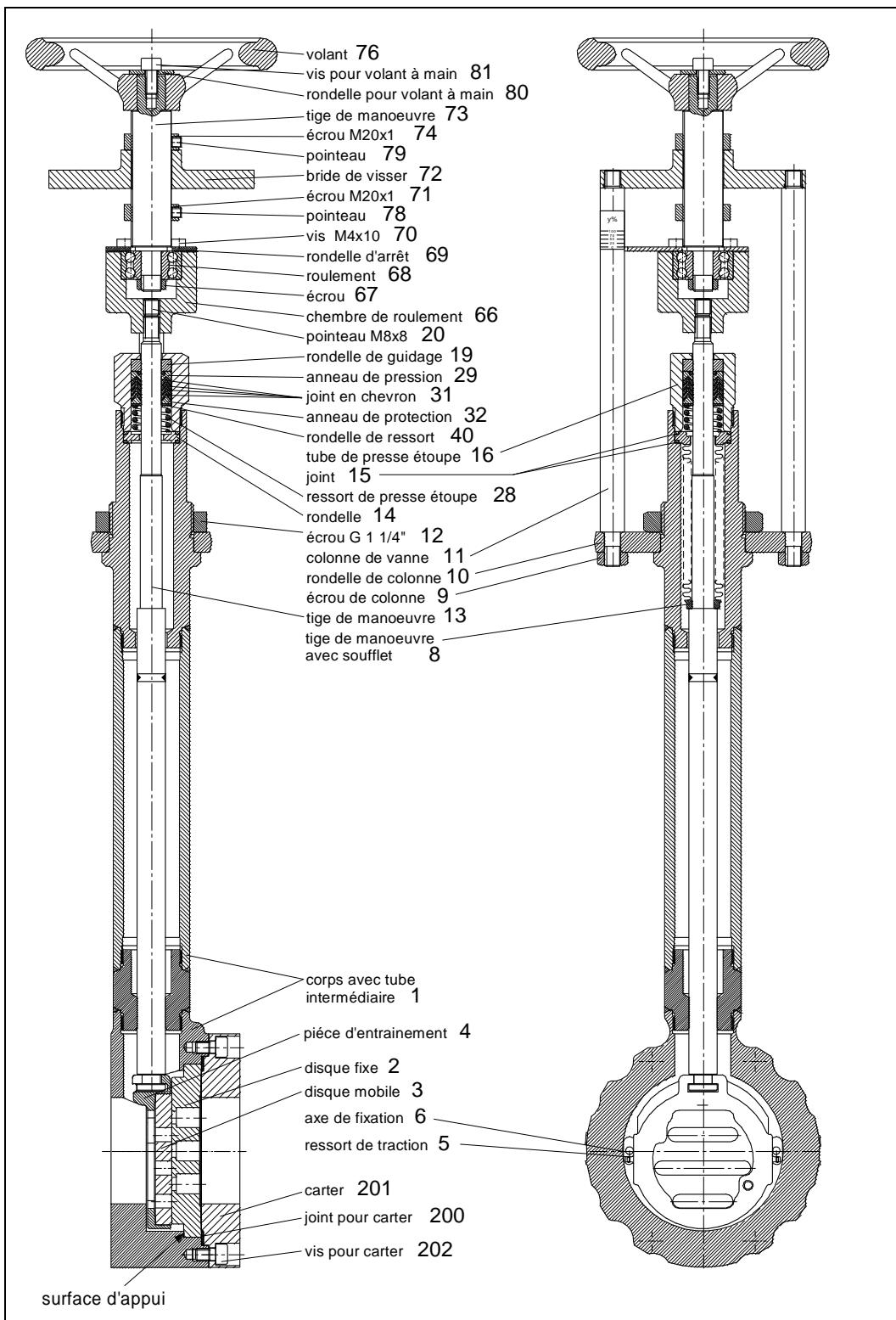
En plus des pièces de rechange, nous proposons également pour toutes les vannes des kits de réparation contenant toutes les pièces d'étanchéité et d'usure.
