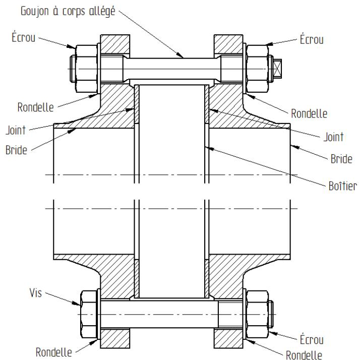
Les filetages des vis doivent être graissés. Les vis doivent être serrées en croix. Pour cela, il faut appliquer 30 % du couple de serrage de consigne lors du premier serrage, 60 % lors du deuxième serrage et 100 % lors du troisième serrage. Le processus doit ensuite être répété avec 100 % du couple de serrage de consigne, jusqu'à ce que les écrous ne puissent plus être tournés en appliquant le couple de serrage de consigne.
