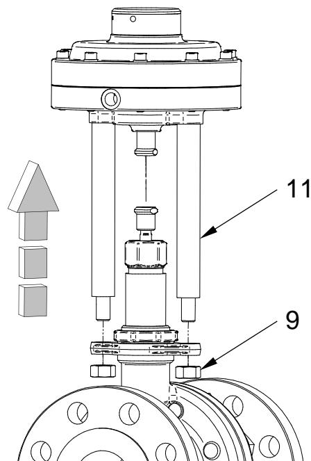
4. Retirer les écrous (221) et rondelles (222), puis retirer la pièce en bout (219).
