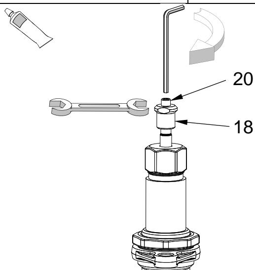
12. Bloquer la position de l'écrou de positionnement (18) à l'aide du pointeau (20).
