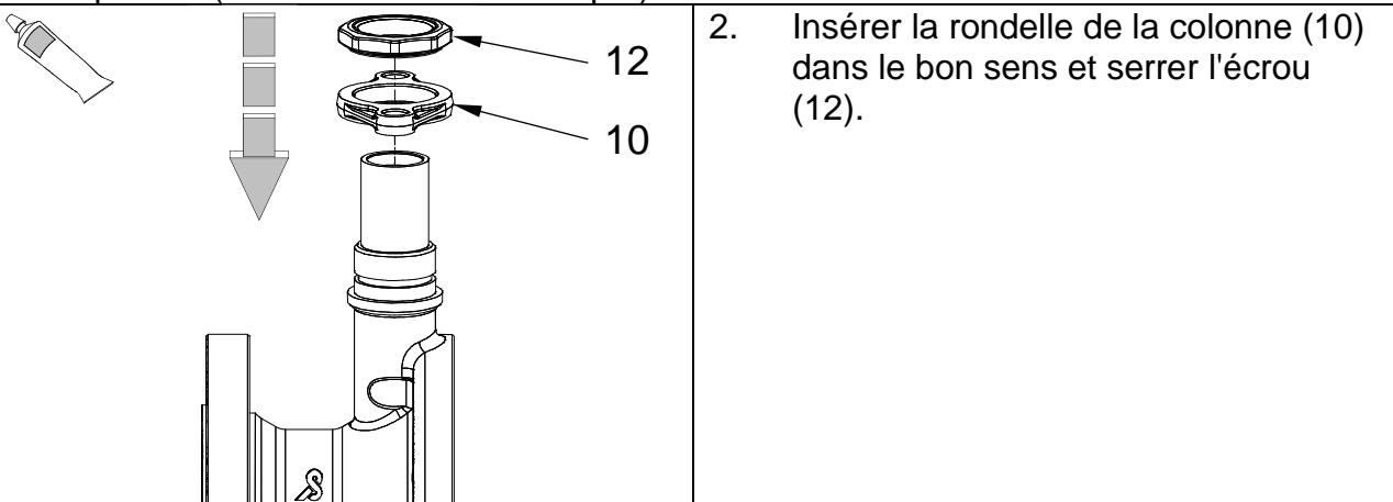
2. Insérer la rondelle de la colonne (10) dans le bon sens et serrer l'écrou (12).
