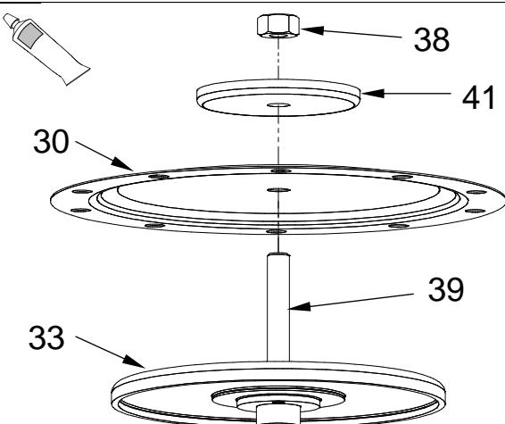
4. Placer le disque de membrane (33), la membrane (30) et l'assiette de membrane (41) sur la vis (39) et les visser à l'aide de l'écrou (38). L'assiette de membrane (41) doit être installée avec le bord arrondi vers la membrane.
