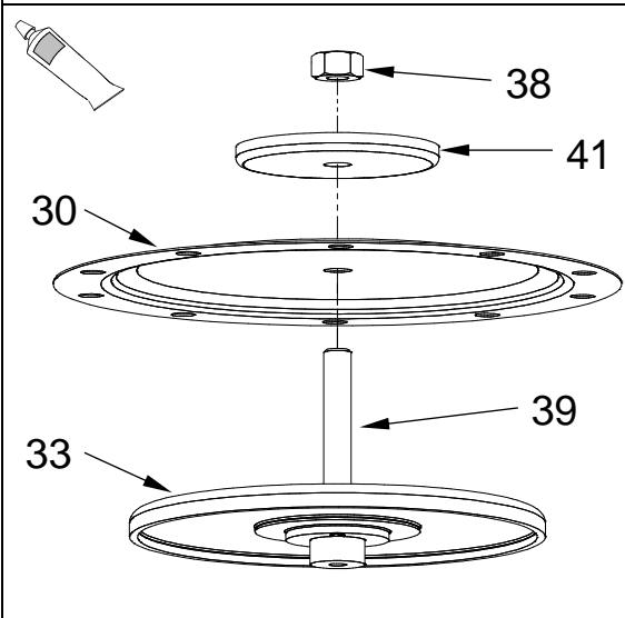
4. Schrauben (39), Membranteller (41), Membrane (30) und Membranscheibe (33) mit Mutter (38) fest verschrauben.
