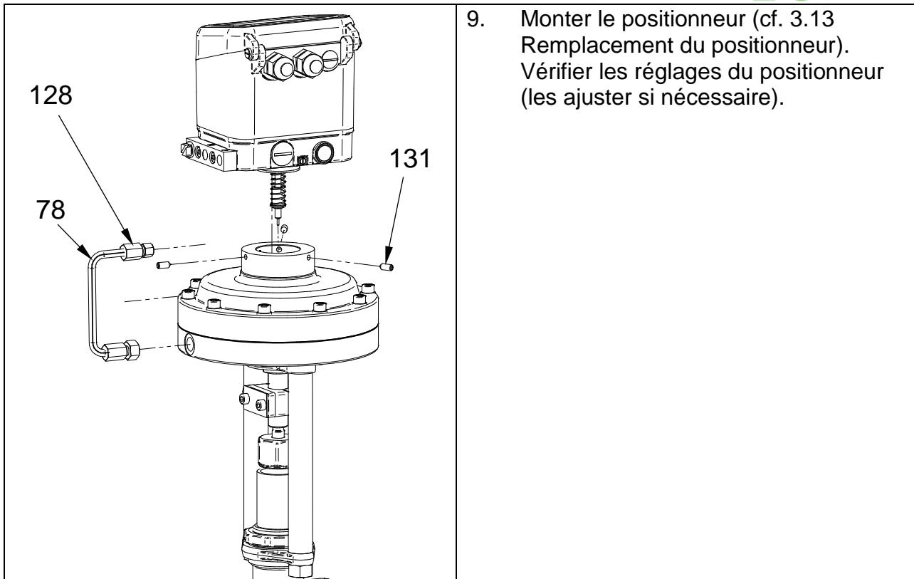
9. Monter le positionneur (cf. 3.13 Remplacement du positionneur). Vérifier les réglages du positionneur (les ajuster si nécessaire).
