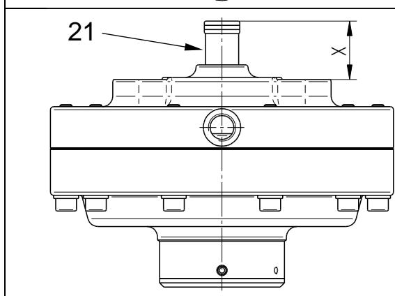
11. Visser l'écrou de positionnement (21). Régler l'écrou de positionnement sur la cote de montage « X » (cf. tableau).
