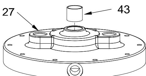
2. DU-buchse (43) in die untere Membranschale (27) einpressen.
