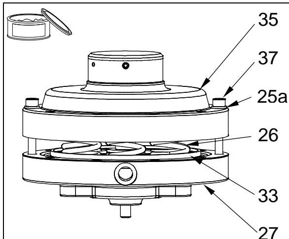
8. Retourner l'ensemble et vérifier à nouveau que les ressorts de pression (26) sont encore complètement à l'intérieur du disque de membrane (33).
