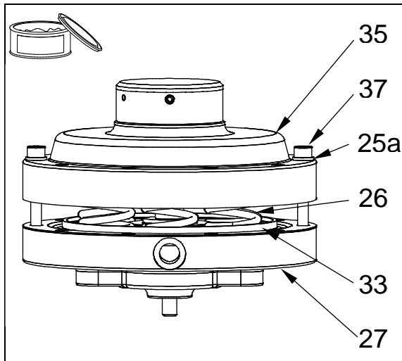
8. Überprüfen Sie erneut, ob sich die Druckfedern (26) noch vollständig in der Membranscheibe (33) befinden.
