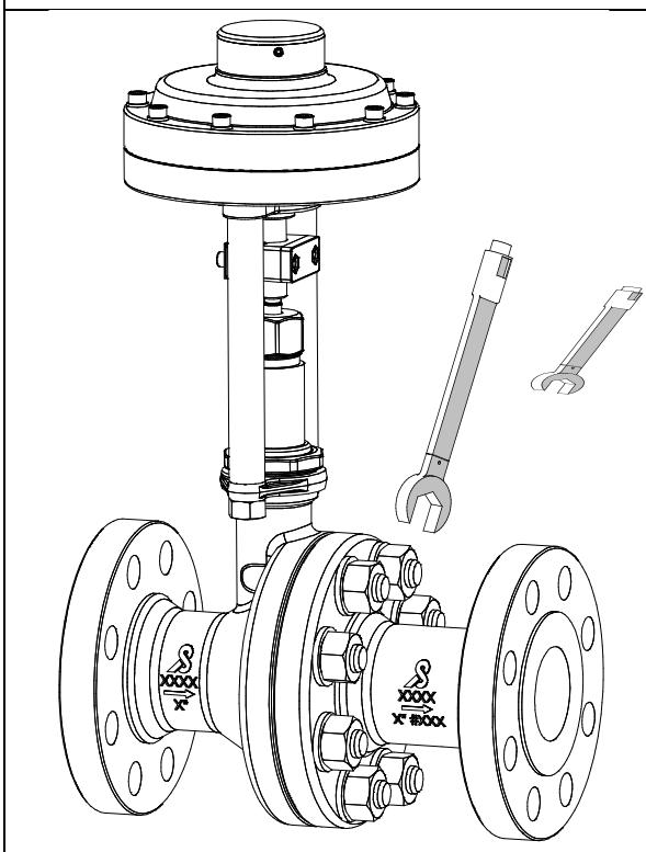
23. Régler la clé dynamométrique au couple approprié.
