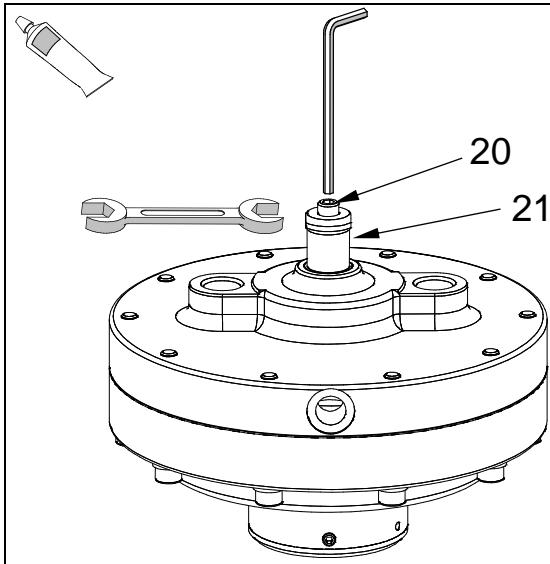
12. Bloquer l'écrou de positionnement (21) à l'aide du pointeau (20).
