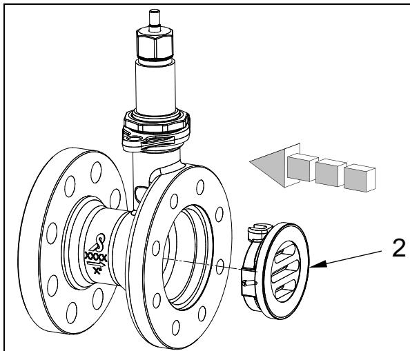
9. Placer le couple glissière dans le corps (1). Vérifier si les fentes des disques sont parallèles lors de la fermeture. Si nécessaire, tourner légèrement le disque (2).
