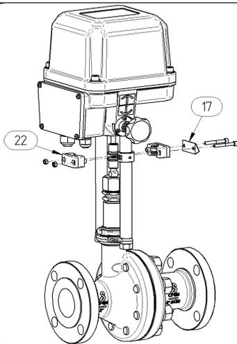
20. Kupplung (22) mit Stellungsanzeigblech (17) montieren.
