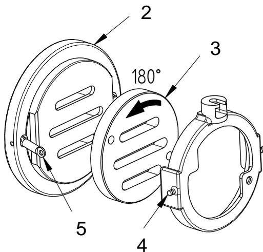
Il est possible d'inverser la fonction de fermeture de la vanne par rotation du disque mobile.
