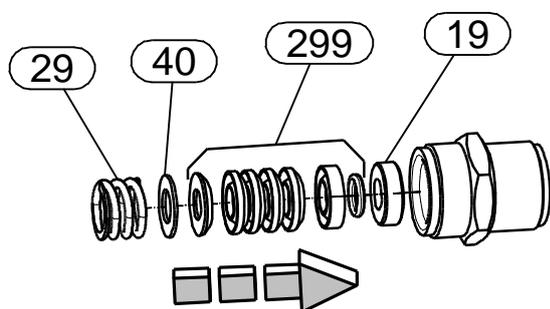
4. Insérer la bague de guidage (19), le presse-étoupe (299), la rondelle (40) et le ressort (28) dans le presse-étoupe (303) dans le bon ordre.
