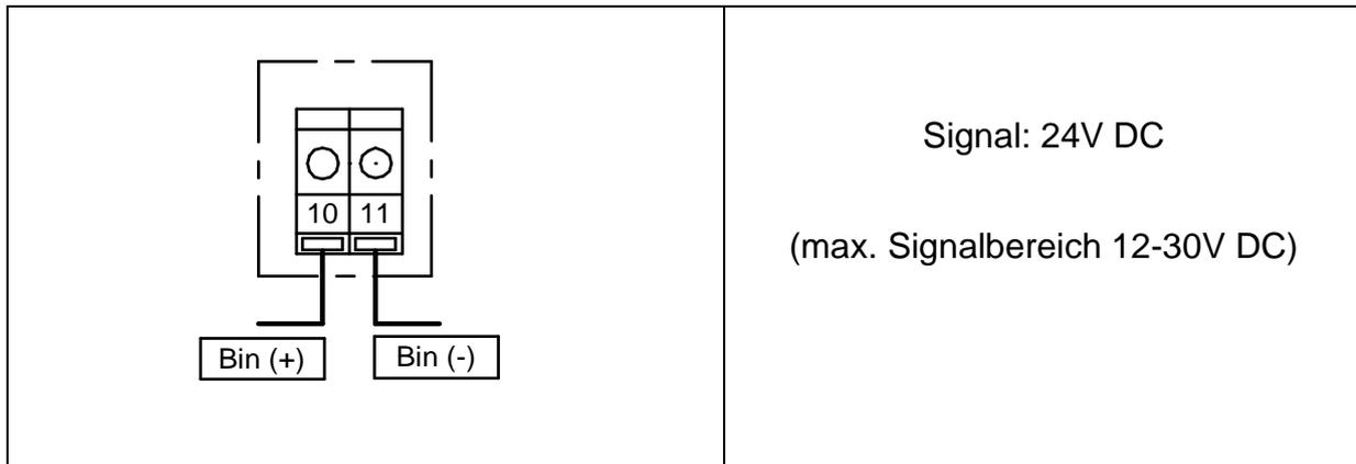
Der Binäreingang überschreibt das anliegende Sollwertsignal und führt die hinterlegte Sonderfunktion aus.
