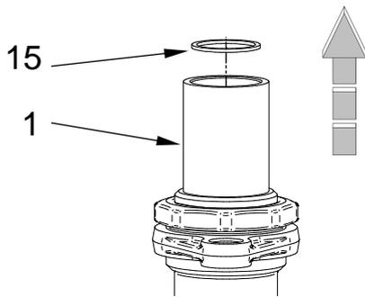
16. Dichtungen (15) vom Gehäuse (1) entfernen.
