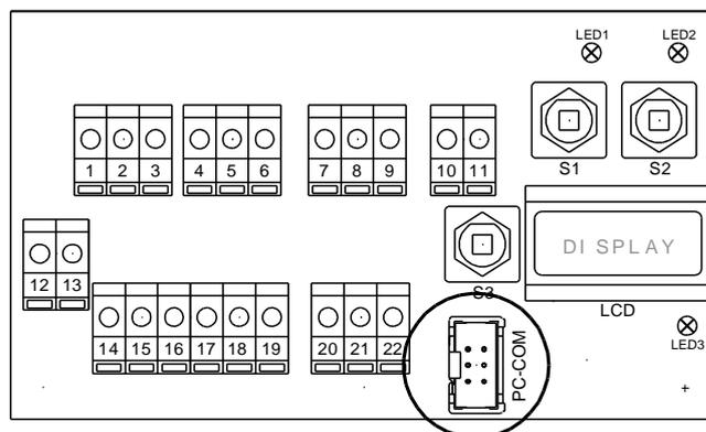
Der Anschluss an einen PC erfolgt über einem speziellen Adapter am Anschluss „PC-COM“ im Klemmraum des Antriebs.
