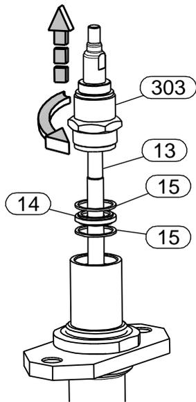
10. Packungsrohr(303) abschrauben und mit Ventilspindel(13) aus dem Gehäuse((1) herausziehen.
