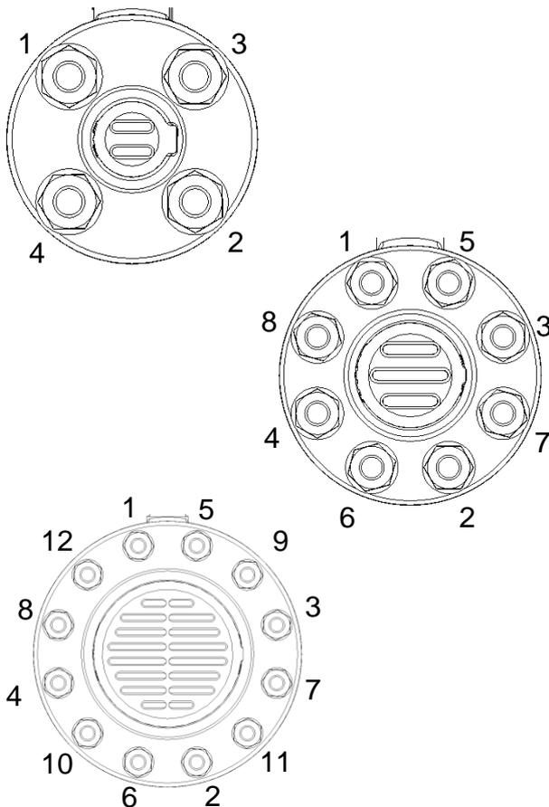
22. Muttern (221) mit dem links gezeigten Kreuzmuster anziehen. Das Anzugsmoment an den Muttern sollte über mehrere Runden schrittweise erhöht werden.
