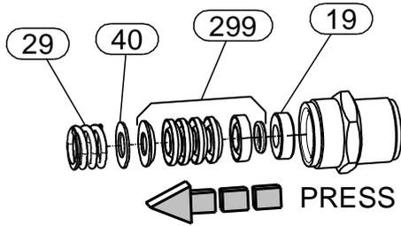
15. Führungsring (19) und Packung mit Montagedorn 4010410 aus Packungrohr (16) herausdrücken.
