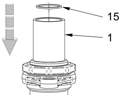
5. Poser le joint du tube intermédiaire (15) dans le corps (1). Faire attention à ne pas endommager les bords du joint.
