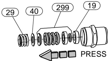
16. Retirer la bague de guidage (19), le presse-étoupe (299), la rondelle (40) et le ressort (29).
