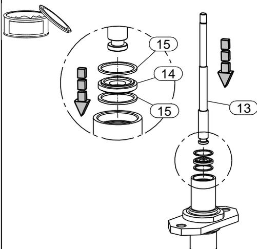
2. Poser la rondelle du tube intermédiaire (14) et les deux joints (15) dans le corps.
