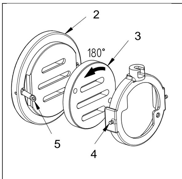
Durch Drehen der beweglichen Dichtscheibe kann die Schließfunktion des Ventils umgekehrt werden.
