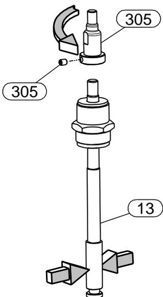
12. Tendre avec précaution l'extrémité inférieure de la tige de manœuvre (13).
