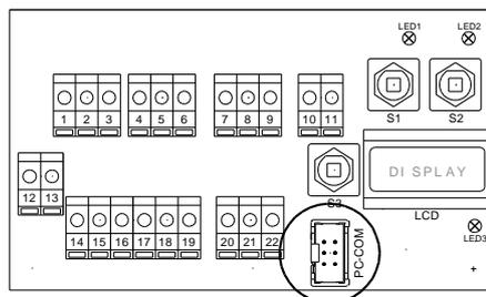
Le raccordement à un PC s'effectue par le biais d'un adaptateur spécial sur la prise « PC-COM » dans le compartiment des bornes de l'actionneur.
