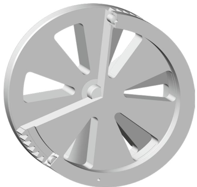
Abb. 2 Das Herz der Segmentplattenventile sind zwei aufeinander gleitende und gegeneinander dichtende Segmentplatten.
