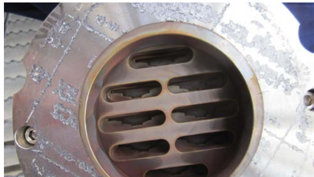
Abb. 7 Das Ventil wurde nach 1 Jahr demontiert und überprüft und keinerlei Schaden festgestellt.
