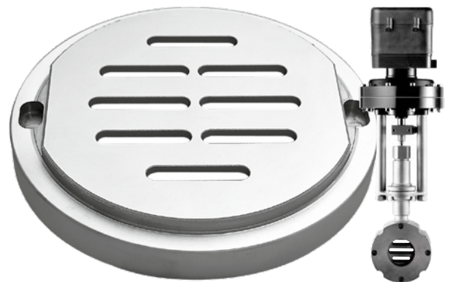
Abbildung 2 Gleitschieberventile eignen sich wegen ihrer hohen Regelgüte und der kompakten Zwischenflanschbauweise hervorragend für den Einbau in Prüfständen.
