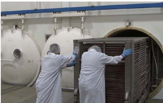
In einem gekühlten Vakuumsystem werden gefrorene Rohmaterialien dehydriert ohne dabei aufzutauen. Das Eis im Produkt sublimiert zu Dunst.
