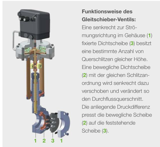
**Funktionsweise des Gleitschieber-Ventils:**
