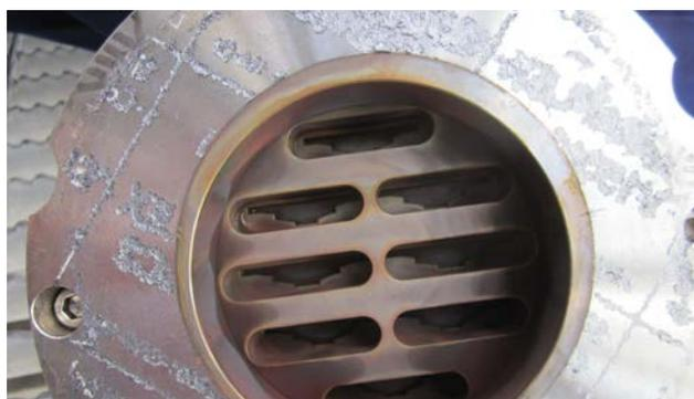
Fig. 7 La vanne a été démontée après 1 an d'utilisation sans dommages. d'utilisation une vérification.
