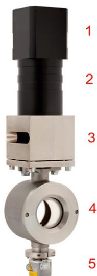
Illustration 1 : Conçue sur une haute précision de réglage – la vanne à secteur sphérique (4) est combinée avec un servomoteur (1) et un engrenage planétaire (2). Avec le capteur d'angle de rotatif absolu (5) la position exacte du secteur sphérique est déterminée sans effort et renvoyée à la commande. En cas de panne de courant, la vanne peut aussi être positionnée en actionnant une commande manuelle de secours (3).
