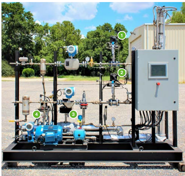
Figure 04 : le TWG abrite plusieurs vannes à glissière de Schubert & Salzer : (1) vanne de régulation du gaz (2) vanne de régulation de l'air (3) régulation de la vapeur (4) événement de vapeur.
